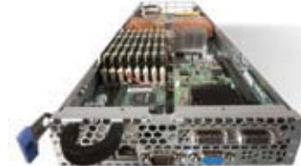
2 процессора AMD Opteron™ 24xx или Intel® Xeon® 55xx, до 64 ГБ ОЗУ, 2 HDD или SSD SATA II 2.5" общим объемом до 1 ТБ
