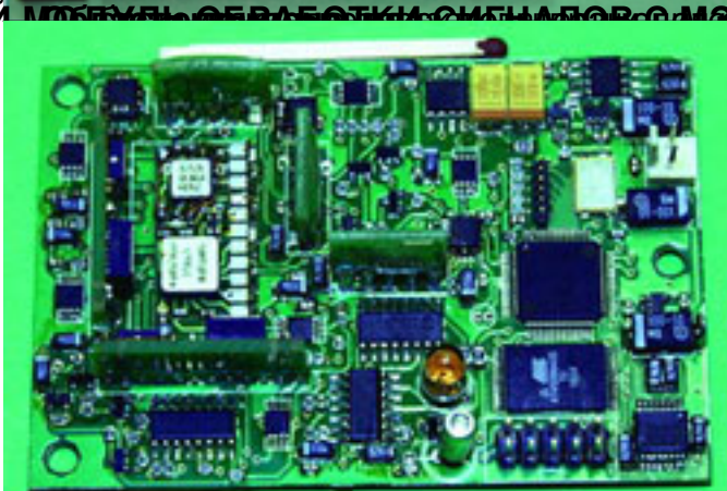
Назначение: прием сигналов от МЭМС - датчиков с последующей цифровой фильтрацией и об
