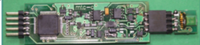
Область применения: измерение напряженности постоянных и переменных магнитных полей с диа
