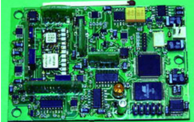
Назначение: прием сигналов от МЭМС - датчиков с последующей цифровой фильтрацией и об
